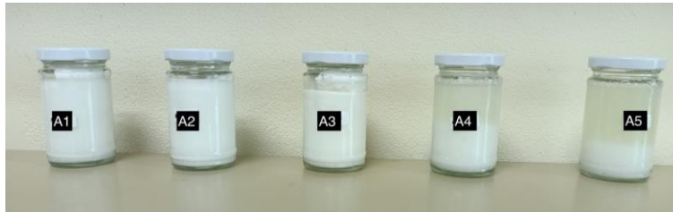
ภาพที่ 4 แสดงลักษณะเนื้อครีมของครีมพื้นสูตรที่มีปริมาณอัตราส่วนของน้ำมันแตกต่างกัน
